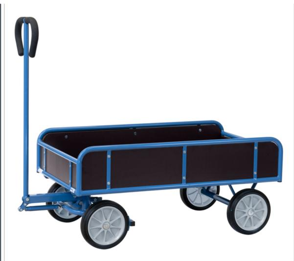
Aus Stahlrohr geschweißt, pulverbeschichtet brillantblau RAL 5007. Geländer 180/250 mm hoch, Ladefläche und Wände aus wasserfestem Sperrholz. Drehschemel-Lenkung mit Deichsel und Handgriff. Deichsel mit Sicherheitshandgriff mit Softgrip-Bezug und automatischer gedämpfter Rückstellung in Ruheposition. Räder mit Vollgummibereifung, Naben mit Rollenlager. Automatische Feststellbremse auf die Vorderräder wirkend.
