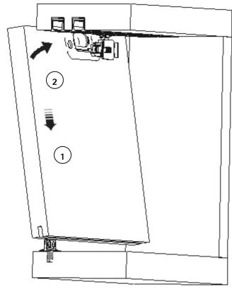
Tür unten in die Führung einsetzen, vorsichtig in Richtung Korupus klappen und an die Laufteile heranführen./
