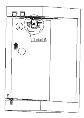
Tür leicht anheben / Lift up the door slightly Rastnasen am Laufteil mit zwei Fingern zusammendücken (siehe Detail A) /
