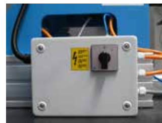
Abb.: Hauptschalter (aus Bediener Sicht seitlich rechts am Maschinengestell)
