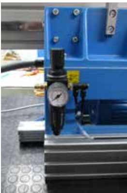
Abb.: Wartungseinheit Pneumatik (aus Bediener Sicht seitlich links hinten am Maschinengestell)
