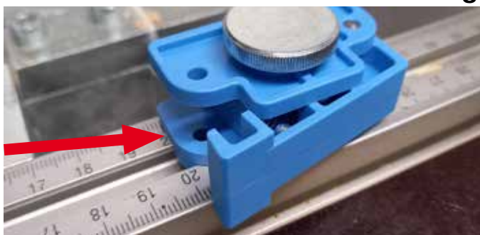
Abb.: Einstellen nach Skala
