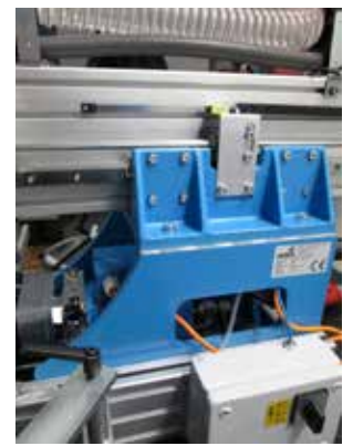
Abb.: Hauptschalter (aus Bediener Sicht seitlich rechts am Maschinengestell)
