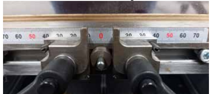
Abb.: Mittenanschlag einstellen
