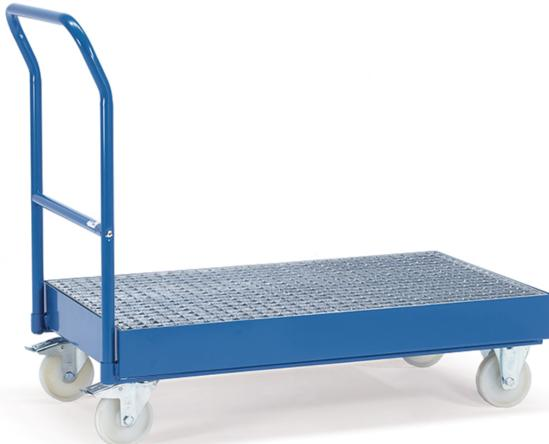
Stahl-Konstruktion geschweißt, Wanne 100 mm hoch, öldicht, pulverbeschichtet blau RAL 5007. Mit bündig eingelegtem Gitterrost, Maschenweite 31 x 31 mm, feuerverzinkt. 2 Lenk- und 2 Bockrollen, Nabenhügel mit Rollenlagerung. Feststeller an den Lenkrollen. Zum Transport von 1 oder 2 200-Liter-Fässer geeignet. Verhindert Schäden durch Tropföl. Auffangwanne 45 Liter.
