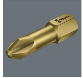
TH-Bits sind extraharte Bits mit Torsionszone. Torsion-Bits sorgen für die Abfederung von Drehmomentspitzen in der Torsionszone. Dadurch wird vorzeitiger Verschleiß vermieden, die Lebensdauer des Bits wird erhöht.
