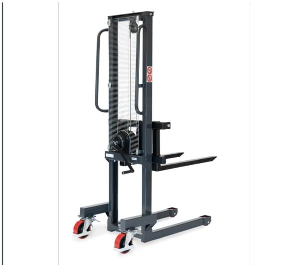
Für den gelegentlichen Einsatz als Hub- und Transportgerät. Stabile Profilstahl-Konstruktion mit Rohrschiebegriffen, pulverbeschichtet anthrazitgrau RAL 7016. Hubantrieb durch Sicherheits-Handwinde. Gabeln verstellbar. Gabelbreite 80 mm. 2 Lenkrollen, Räder Polyurethan-Bereifung und 2 Gabelrollen Nylon. Lenkrollen mit Feststeller. Lastschwerpunkt Abstand: 500 mm. Hub pro Kurbelumdrehung: 22 mm. 2 Jahre Garantie
