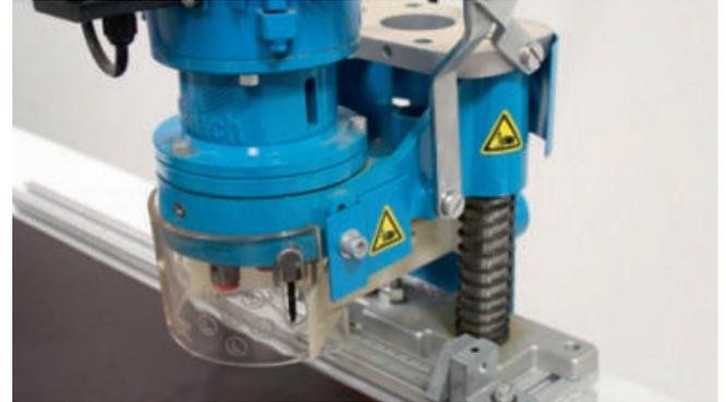
Abb. 4: Verschiebbare Schutzscheibe an Bohrspindeln
