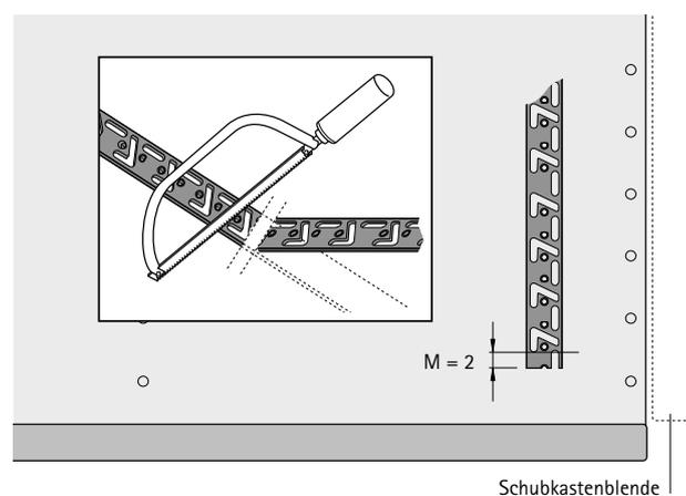
Wird eine Stop Control Verriegelungsstange gekürzt, so ist ein Mindestabstand  $M = 2$  mm einzuhalten
