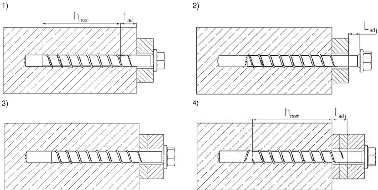
Es ist zulässig, die Schraube bis zu zwei Mal zum Justieren zu lösen.
