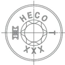
Kopfkennzeichnung bei  $d = 6,0$  bis  $12,0$  der Ausführungen: Flachsennkopf.
