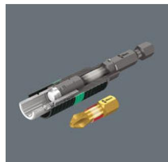
Die optimal abgestimmten Kennlinien der Torsionszonen von Bit und Halter ermöglichen ein abgestuftes Nachgeben bei Belastung. Das zweistufige System verhindert frühzeitigen Verschleiß. Darüber hinaus ist ein langes Werkzeugleben auch durch die auf die jeweilige Anwendung ausgelegte Härte der Bits garantiert.
