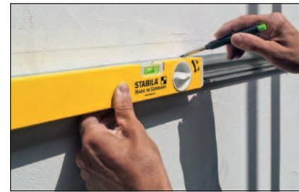
Anreißkante über die volle Länge – messen und anzeichnen in einem Arbeitsgang, auch im ausgezogenen Zustand
