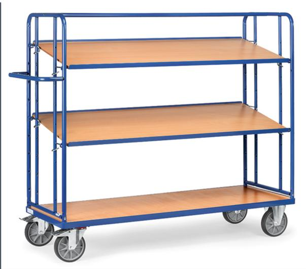
Stahlrohr-/Profilstahl-Konstruktion, pulverbeschichtet RAL 5007. 1 fester und 2 lose Böden aus Holzwerkstoffplatte, Oberfläche Buchendekor, eingelegt in Winkelstahl mit 15 mm hohem Rand an den Längsseiten. Lose Böden variabel einlegbar, Einhängeraster 120 mm. Mögliche Neigung bei schräger Einhängung ca. 15 und ca. 30 Grad. Tragkraft pro Einlegeboden 80 kg. 2 Lenk- und 2 Bockrollen, TPE-Bereifung, Naben mit Rillenkugellager. Feststeller an den Lenkrollen.
