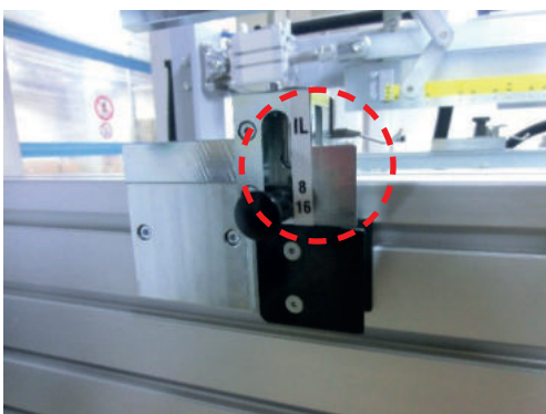
Aufnahmestempel in der Position UNTEN (16) und Nase des Aufnahmeestücks UNTEN für Inlay-Zarge mit 16 mm Bodendicke. Anschlagstift und Befestigungsschraube sind montiert! (Variante NEU)
