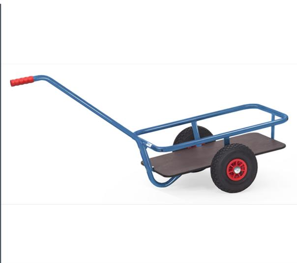
Leichter und sehr handlicher Handwagen aus Stahlrohr geschweißt, pulverbeschichtet blau RAL 5007. Deichsel anschraubbar. Ladefläche aus wasserfestem Sperrholz. Räder mit Luftbereifung, Naben mit Rollenlager. Zerlegte Anlieferung. Leichte Selbstmontage.
