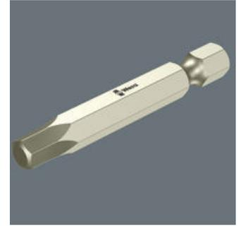
Durch den Einsatz von Edelstahl-Bits wird die Entstehung von Rost auf Edelstahl-Schrauben oder Edelstahl-Oberflächen vermieden. Fremdrost auf Edelstahl entsteht vorwiegend durch Abrieb beim Verschrauben mit herkömmlichen Stahlwerkzeugen. Der Abrieb hinterlässt festhaftende Stahlpartikel, die unter Einwirkung von Sauerstoff zu Rost werden.
