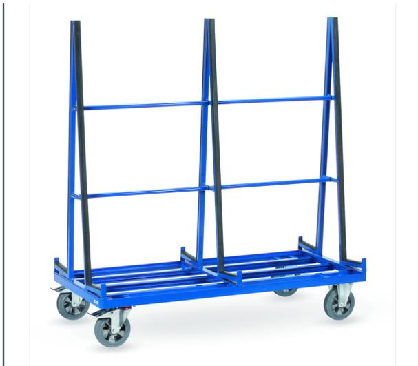
Baukasten-System: zum sicheren Transport von Glasscheiben, Holz- und Kunststoffplatten sowie kompletter Fenster und Türen. Profilstahl und Stahlrohr geschweißt. Pulverbeschichtet, blau RAL 5007. Zweiseitige Anlagen mit Profilmgummi belegt. Auflagebreite 2 x 230 mm, Anlagehöhe 1450 mm. 2 Lenk- und 2 Bockrollen, Vollgummi-Elastic-Bereifung, blaugrau "spurlos", Naben mit Kugellager. Feststeller an den Lenkrollen.
