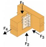
Charakteristische Tragfähigkeiten - Holzbalken an Stütze -  $R_{3,k}$  und  $R_{4,k}$
