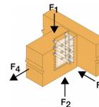
Charakteristische Tragfähigkeiten - Holzbalken an Holzbalken -  $R_{3,k}$  und  $R_{4,k}$
