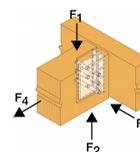
Charakteristische Tragfähigkeiten - Holzbalken an Stütze
