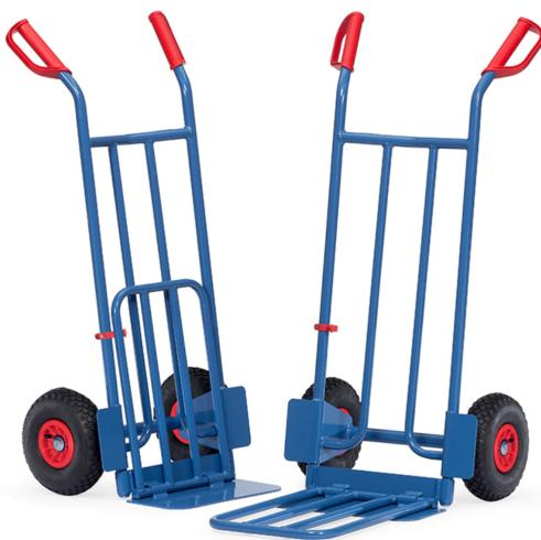
Handlich, mit großer Stahlrohr-Klappschaufel 500 x 330 mm. Stabile Schweißkonstruktion, pulverbeschichtet, blau RAL 5007. Sicherheitsgriffe. Räder mit Luftbereifung auf Kunststoff-Felgen. Nabenhügel oben und Querstreben durchgebogen. Für den sicheren Transport von runden Gütern, wie Rollen, Kannen, Eimern usw. Zerlegte Anlieferung.
