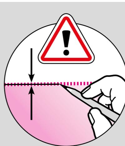
Arbeiten Sie beim Markieren und Ausrichten immer auf der Mitte der Laserlinie !
