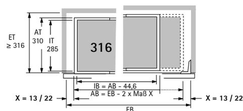
AB = Außenbreite    EB = Einbaubreite    IB = Innenbreite
