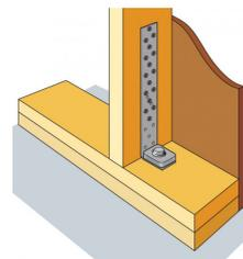
Fig.3 : Installation innenliegend
