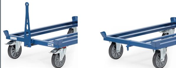
Deichsel und Kupplungszapfen für Paletten-Fahrgestelle. Für den Transport mit Zugfahrzeugen bis 6 km/h. Züge bis 5 Fahrgestelle möglich. Maximales Zuggewicht 2.000 kg. Deichsel aus Flachstahl, stellt sich mittels Gasdruckfedern selbsttätig in senkrechte Ruheposition. An der Bockrollenseite befindet sich ein stabiler profiliert Kupplungsbolzen. Verbindung durch Fußbetätigung möglich.
