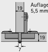
Auflage 5,5 mm | Spreizmuffen Bohrung $\varnothing$ 5 x 11 | mit             | Topf      | 0 077 734             | 0 077 735            | 0 077 736                      | 0 077 887                     | 0 010 074             | 0 077 942            | 1/50 St. |
