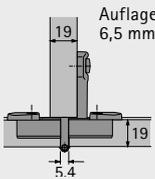
Auflage 6,5 mm | Spreizmuffen Bohrung $\varnothing$ 5 x 11 | mit             | Topf      | 0 077 734             | 0 077 735            | 0 077 736                      | 0 077 887                     | 0 010 074             | 0 077 942            | 1/50 St. |
