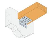
Holz an Beton - 1 Winkel pro Anschluss (für Lastrichtung F4)
