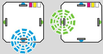
Gerät ist ausserhalb des Selbstnivellierbereiches
