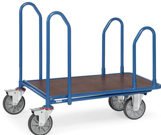
C+C-Wagen (Baumarktwagen / Einkaufswagen) - Stahlrohrkonstruktion, pulverbeschichtet, Ladefläche mit rutschsicherer Siebdruckplatte aus wasserfestem Sperrholz. Mit 2 Seitenbügeln 680 mm hoch und 2 Seitenbügeln (an der Bockrollenseite) 500 mm hoch. 2 Lenk- und 2 Bockrollen, TPE-Bereifung, Nabens mit Rillenkugellager. Feststeller an den Lenkketten. Ineinanderschiebbare Wagen, dadurch 75% Stellraum-Einsparung. Lichte Ladeflächenbreite: 635 mm.
