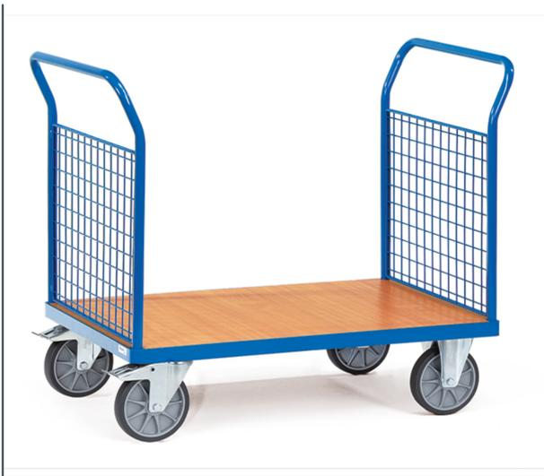
Stahlrohr und Profilstahl geschweißt, pulverbeschichtet RAL 5007, Plattform Holzwerkstoffplatte, Oberfläche Buchendekor. 2 Stirnwände aus Drahtgitter 50 x 50 x 4 mm, Wände 500 mm hoch. 2 Lenk- und 2 Bockrollen, TPE-Bereifung 200 x 40 mm, Naben mit Rillenkugellager. Feststeller an den Lenkrollen.
