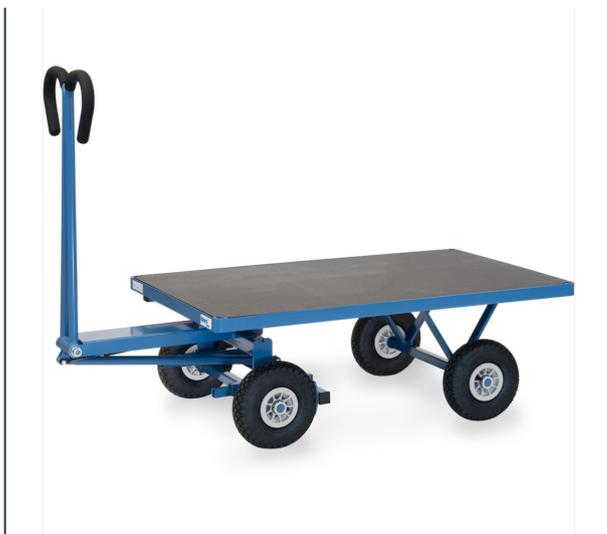
Baukasten-System: Aus Profilstahl geschweißt, pulverbeschichtet blau RAL 5007, 4 Eckhülsen. Drehschemel-Lenkung mit Kugelkranz, Scherendeichsel mit Sicherheits-Handgriff mit Softgrip-Bezug und automatischer gedämpfter Rückstellung in Ruheposition. Ladefläche belegt mit rutschsicherer Siebdruckplatte aus wasserfestem Sperrholz. Räder mit Luftbereifung, Naben mit Rollenlager. Automatische Feststellbremse auf die Vorderräder wirkend.
