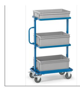
Beistellwagen mit Eurokästen. Stahlrohr- und Profilstahl-Konstruktion, pulverbeschichtet, blau RAL 5007. Mit 3 Kunststoffkästen: 1 St. 600 x 400 x 145 mm und 2 St. 600 x 400 x 220 mm. 2 Lenk- und 2 Bockrollen, TPE-Bereifung, Naben mit Rillenkugellager. Feststeller an den Lenkrollen. Tragkraft obere und mittlere Ladefläche 50 kg.
